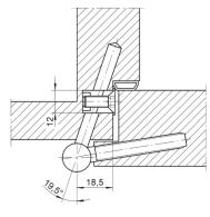
mörteldichte Hinterschweißtasche für Stahlzargen
